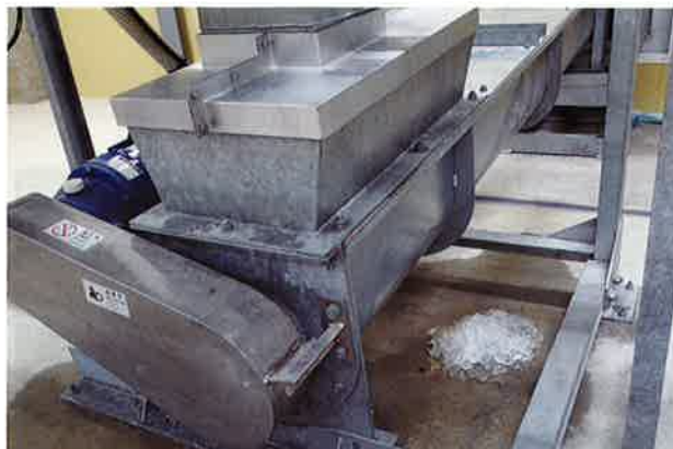
↑製氷機からコンベアーに氷が落ちる部分
