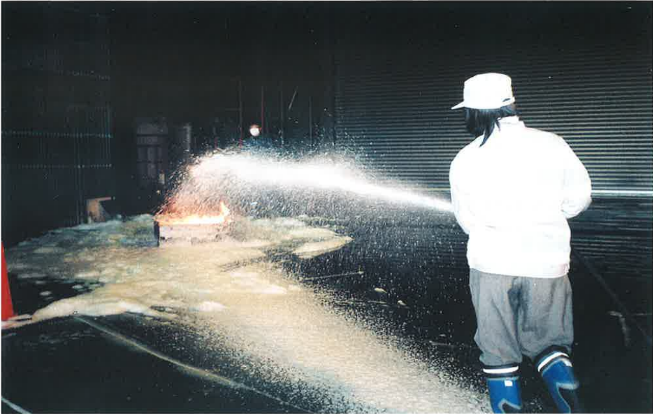
▲パッケージ型 泡消火設備MIDEXⅢの 消火実験（㈱環境設備計画 宮原さん）
